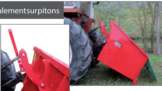
■ Commande du basculement par levier à verrouillage automatique
